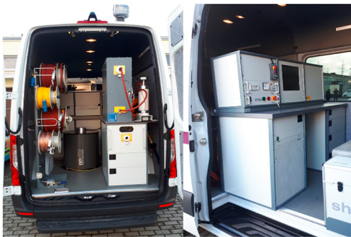
Fot. 1. Wóz pomiarowy do prób napięciowych DAC i VLF
