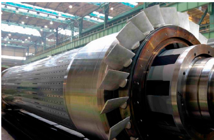
Fot. 1. Nowe wentylatory wirnika turbogenerators
