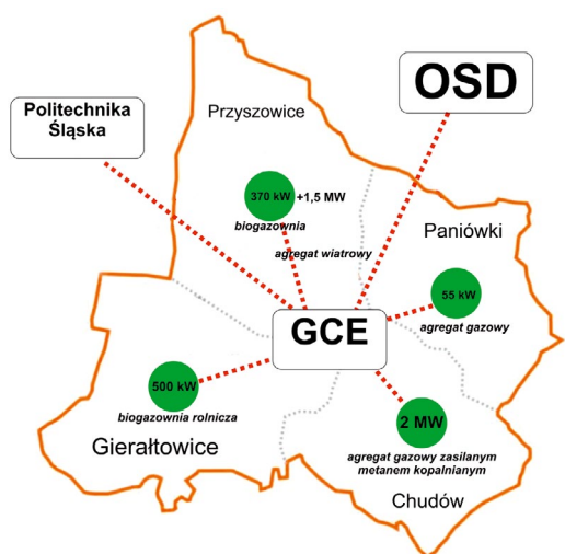
Rys. 9. Schemat czterech minicentrow energetycznych gminy, docelowo ok. 5 MW zainstalowanej mocy wytwórczej
