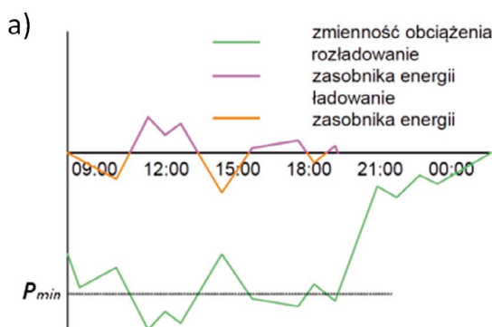
Rys. 1. Wyrównywanie obciążeń; a) ograniczenie szczytowego obciążenia, b) przeniesienie szczytowego obciążenia na dolinę nocną [3]
