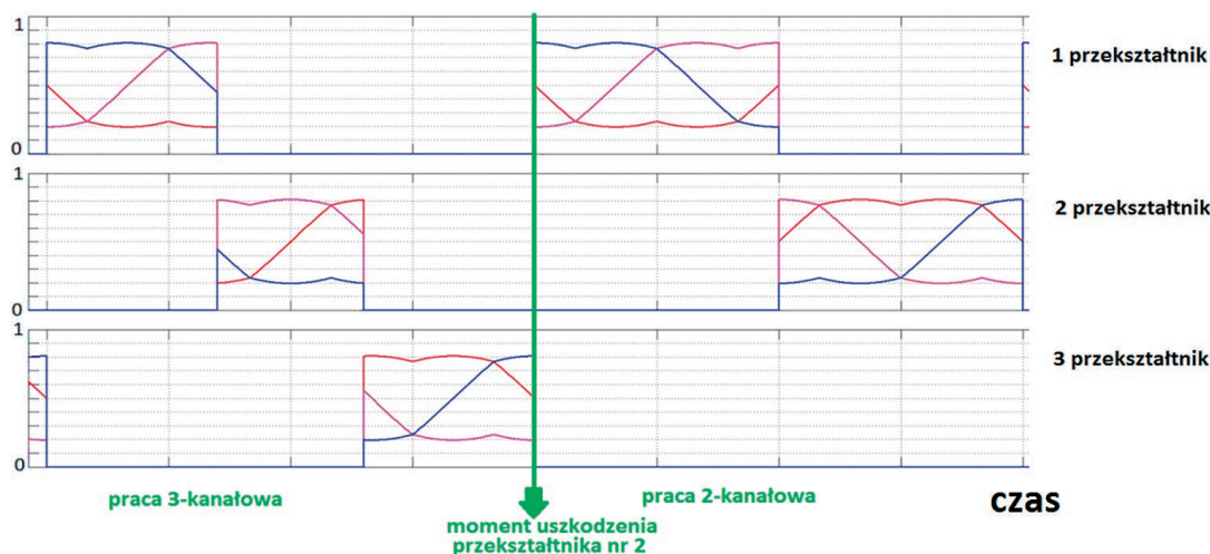
Rys. 7. Idea przełączenia pracy 3-kanalowej na pracę 2-kanalową – sygnał sterujący w module SVM
