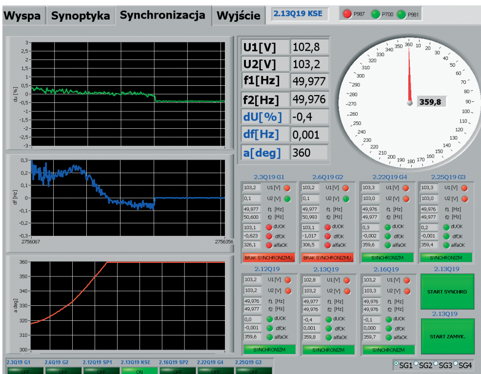
Rys. 4. Synchronizacja układu wyspowego EC zakładu przemysłowego z SEE
