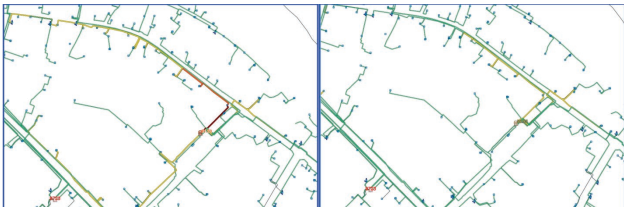
Rys. 5. Wpływ optymalizacji układu pracy sieci na ciągi zasilające. Po lewej układ normalny – lipiec, po prawej układ po zoptymalizowaniu – sierpień
