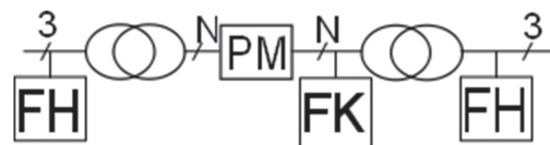
Rys. 1. Schemat blokowy przesuwnika fazowego z przekształtnikiem macierzowym (PM); FK – filtr komutacyjny, FH – filtr harmonicznych
