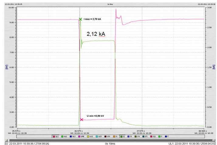
Rys. 8. Prąd skuteczny fazowy I L2 i napięcie minimalne U L1 w polu 4 Tr2 podczas zwarcia 3-fazowego o czasie trwania dt = 579,93 ms; pracują dwie elektrownie GE – 2,5 MW, próba 1
