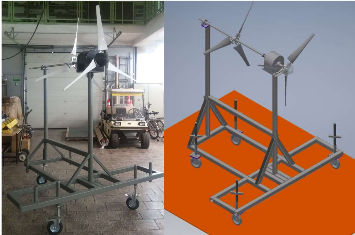
Rys. 10 Widok prototypu turbiny dwuwirnikowej, model 3D oraz prototyp
