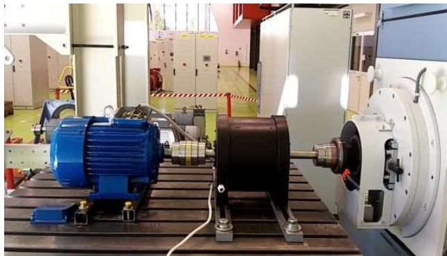
Rys. 17 Generator na stanowisku prób laboratoryjnych
