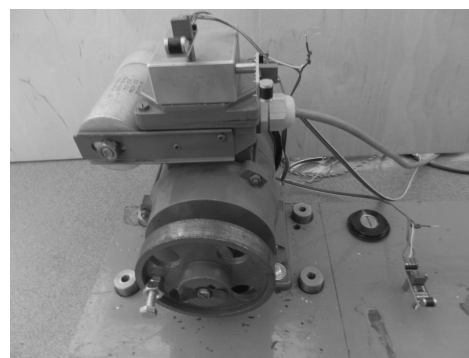
Rys. 1. Stanowisko do badania drgań silnika
