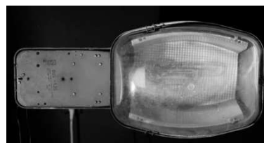
Rys. 3. Oprawa OUS150 z kloszem po wyczyszczeniu
