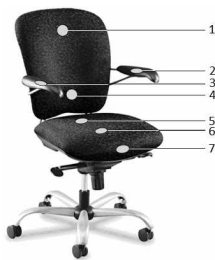
Rys. 1. Rozmieszczenie czujników w systemie CAPRIO [12]
