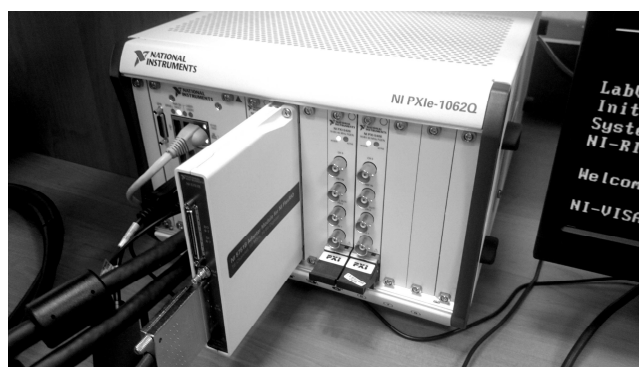
Rys. 3. Kasetka NI PXI 1062Q z wysuniętym modułem NI-RIO
