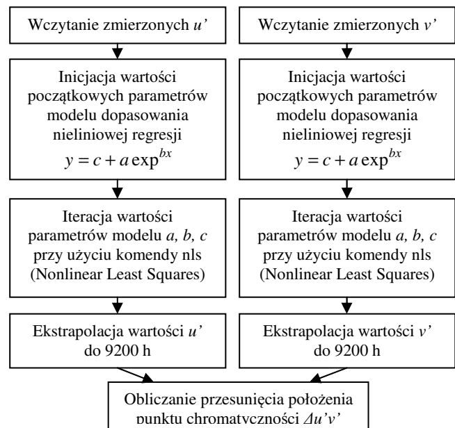
Rys. 3. Schemat proponowanej metody predykcji położenia punktu chromatyczności
