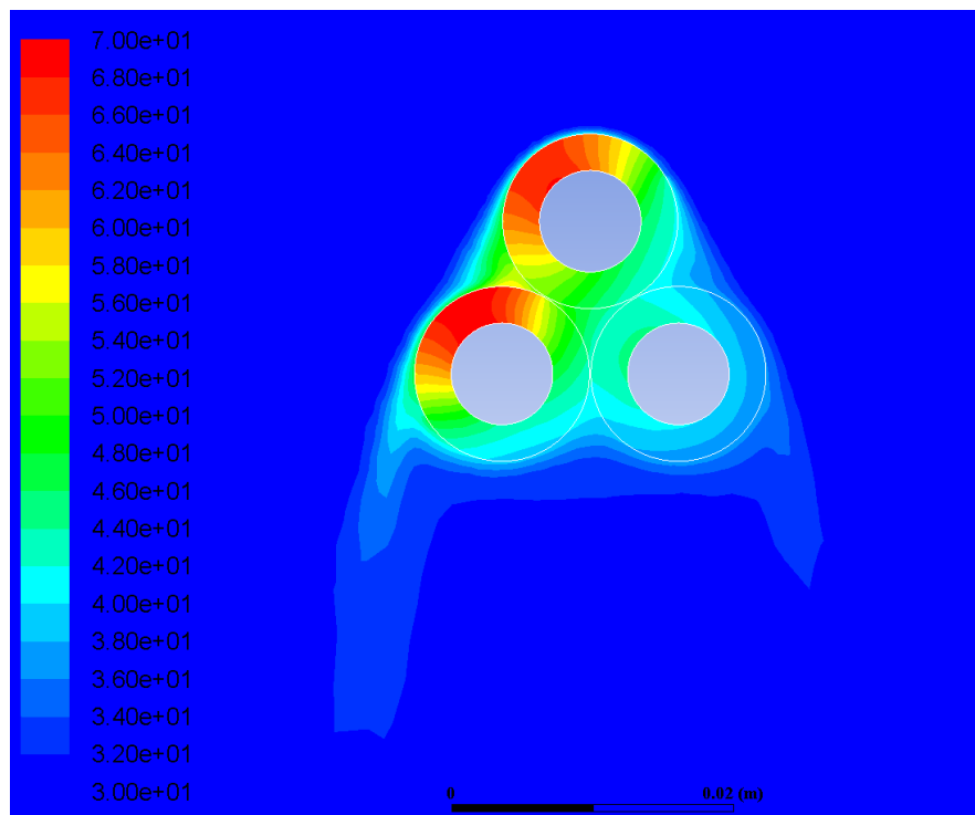
Rysunek 18. Rozkład temperatury dla kabli ułożonych w układzie trójkątnym symetrycznym
