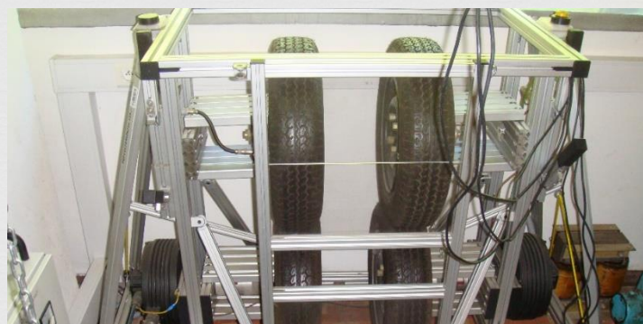
Stanowisko do badań napędu bezpośredniego kół pojazdu
