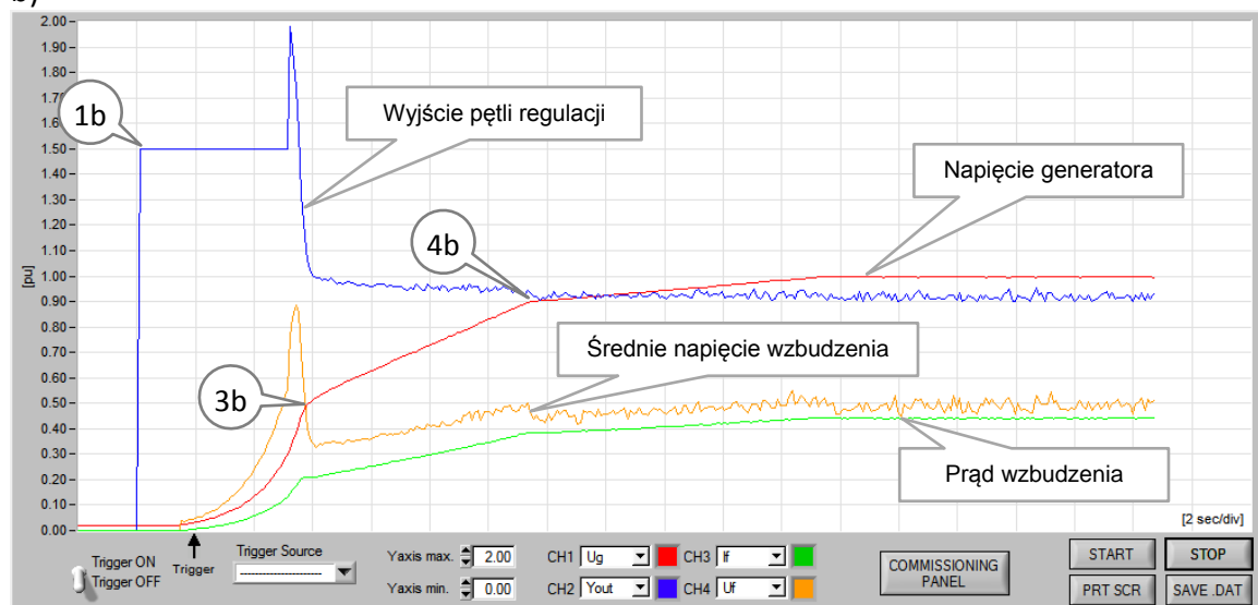
Rys. 4.2. Metody wzbudzenia generatorów na przykładzie wykonanych przez autora testów: a) wzbudzenia turbogeneratora (JWCD) o mocy 459 MVA metodą pełnego ograniczenia sygnału wyjściowego przy ustalonej wartości zadanej napięcia generatora [42], b) wzbudzenia hydrogeneratora (JWCD) o mocy 76 MVA metodą częściowego ograniczenia sygnału wyjściowego ze zwiększaniem wartości zadanej napięcia generatora [43]
