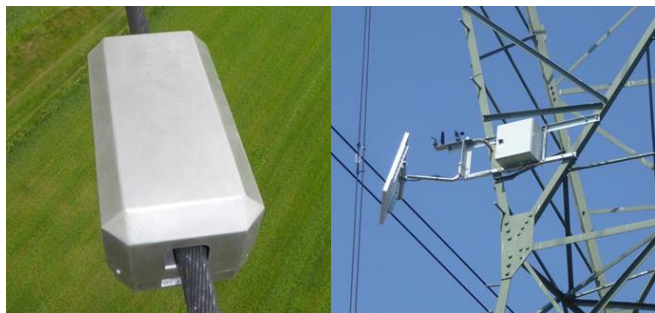
Rys. 1. Zdjęcie rejestratora badawczego na przewodzie i stacji bazowej na słupie linii 400 kV
