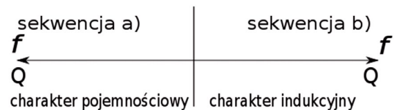
Rys. 8. Zależności pomiędzy sekwencją przełączania kluczy, częstotliwością przełączania kluczy, wielkością generowanej mocy biernej ( Q ) i jej charakterem dla PM obciążanego pojemnościami
