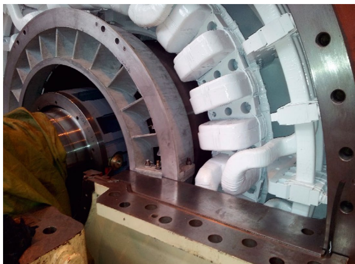
Fot. 3. Nowa osłona wentylatora wirnika z tylnymi łopatkami kierowniczymi
