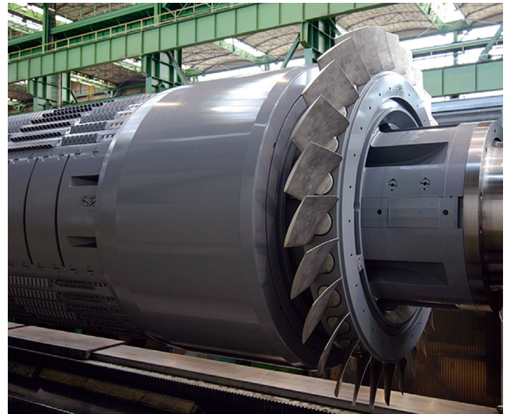
Fot. 1. Wirnik turbogenerators z zabierakowymi klinami żłobkowymi i nowym wentylatorem osadzonym na wale
