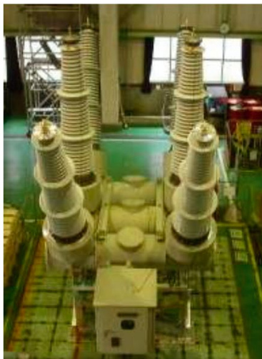
Konstrukcja dead tank . Napięcie znamionowe: 168/204 kV; prąd znamionowy: 2000 A; prąd zwarciaowy: 40 kA; izolacja dodatkowa: SF 6 ; liczba komór próżniowych: 2/fazę; mechanizm: sprężynowo-zasobnikowy
