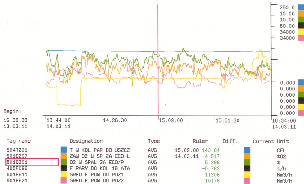
Rys. 19c Działanie UAR zawartości tlenu w spalinach podczas prób odbiorczych ARCM
