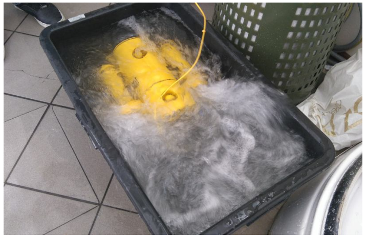
Robot STUART podczas testu pędników w wannie testowej
