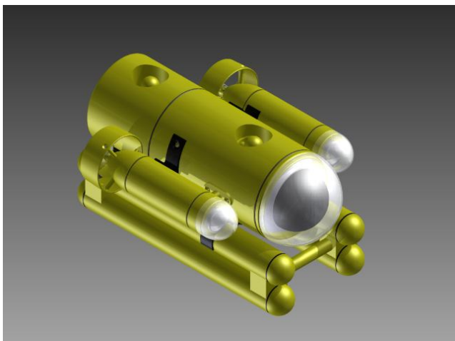
Model trójwymiarowy robota podwodnego STIUART przygotowany w środowisku do modelowania Autodesk Inventor
