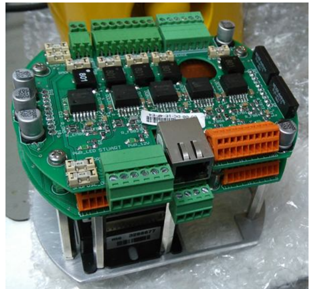
Zmontowane płyty elektroniczne wraz z zamontowanymi od dołu sterownikami silników – zespół gotowy do montażu końcowego
