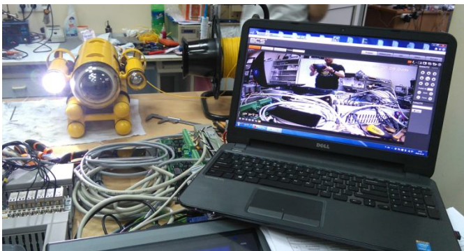
Test transmisji obrazu pokładowej kamery IP. Połączenie bezpośrednie komputera do kamery poprzez sieć bezprzewodową tworzoną przez router umieszczony w bębnie kablowym
