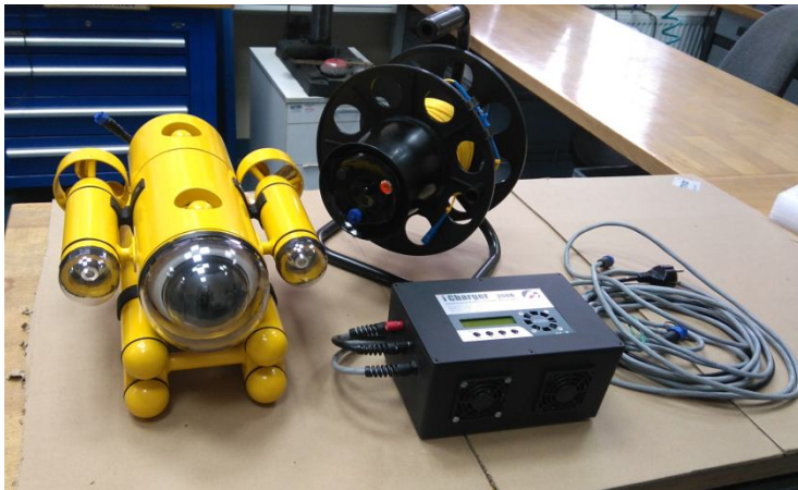
Robot i akcesoria robota po zakończeniu montażu wszystkich komponentów: ładowarka do robota i bębna kablowego, bęben kablowy z nawiniętym kablem światłowodowym.
