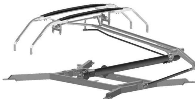
Rys. 6. Końcowe złożenie odbieraka – plik IAM
